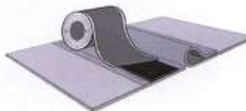
**7-й шаг:** Проверьте правильное расположение ленты – она должна лежать ровно по кромке полотна. Прижмите ленту к пленке приглаживанием.
