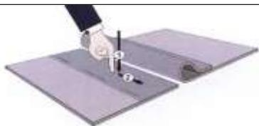
**6-й шаг:** Уложите ленту 7,5 или 15,5 см вдоль кромки мембраны. Лента шириной 7,5 см (3") используется для склеивания стандартных стыков без специального механического крепления на стыке. Лента шириной 15,5 см (7") используется для склеивания стыков с механическим креплением в центре, внутри стыка (кровельные работы).
